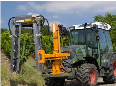
Abbildung 12: Laubschneider mit rotierenden Messern im Frontanbau
