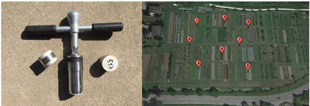
Abbildung 2: Verwendeter Stechzylinder und Verteilung der Probenahmen (Quelle: Links: eigenes Foto, rechts: Google 2019)
