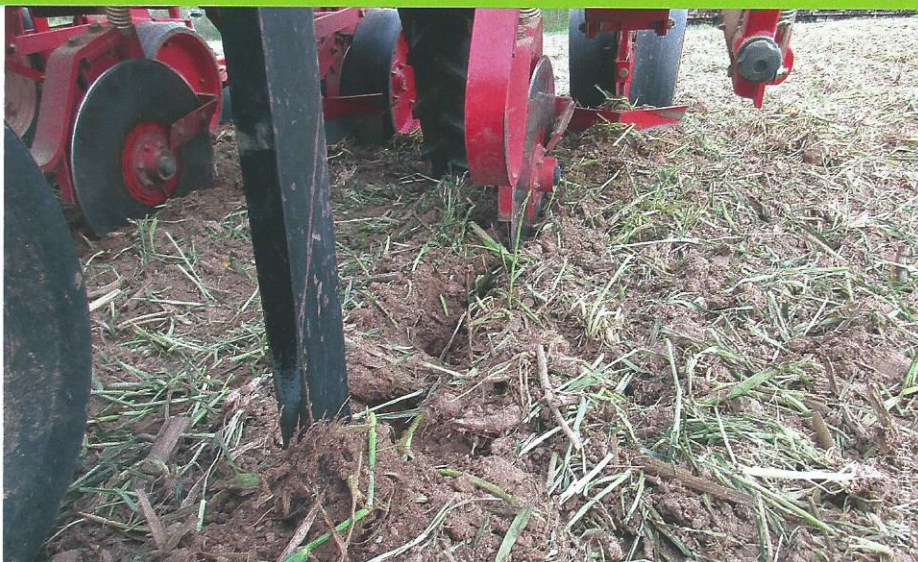
Einzelkornsaat von Mais nach Flächenrotte mit Lockerungsdornen.
