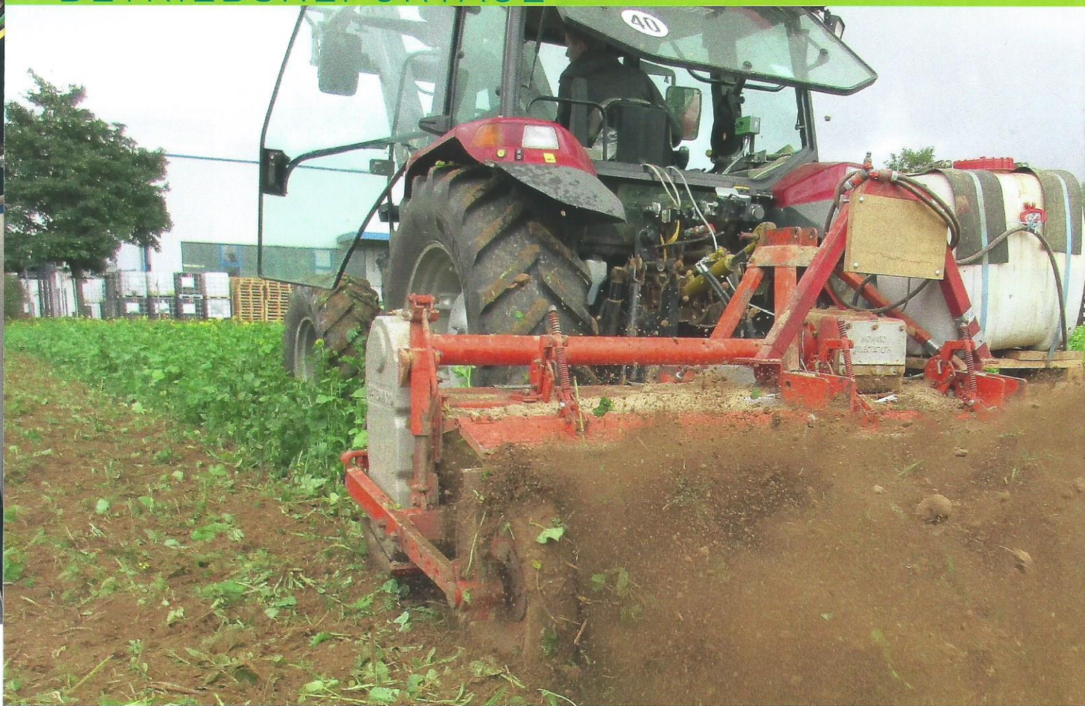
Schälen einer Zwischenfrucht mit einer umgebauten Howard-Fräse: Einleitung der Flächenrotte.
