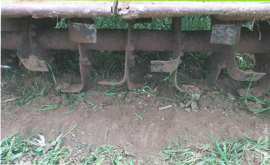
Die Fräsmesser müssen den Bewuchs ganzflächig abschneiden.
