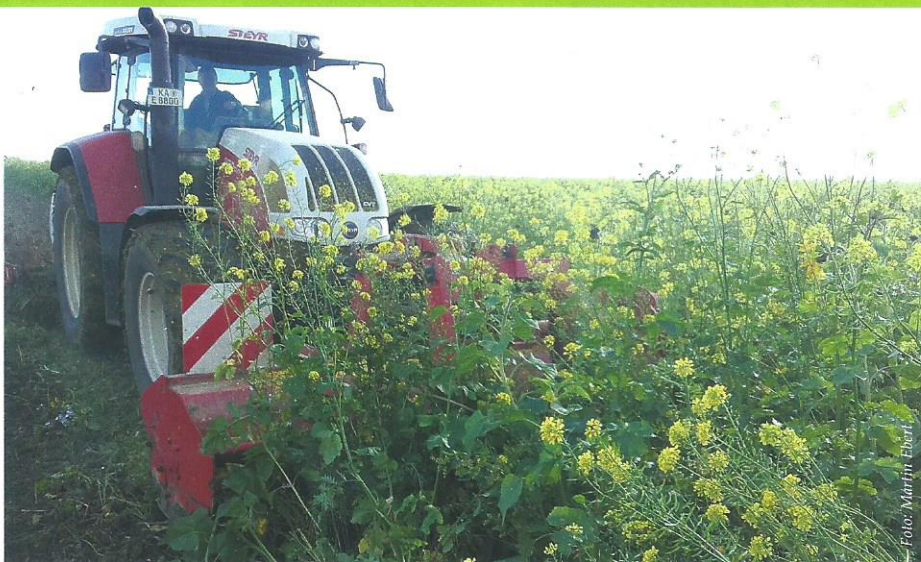
Zerkleinerung und Einarbeitung hoher Zwischenfruchtbestände zur Flächenrotte, mit einem Schlegelmulcher im Frontanbau und einer Schälfräse im Heck.
