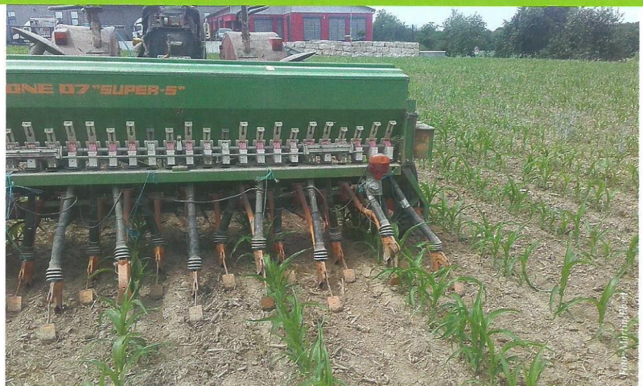
Einbringen von Untersaaten in die Reihenzwischenräume mit einer mechanischen Sämaschine.
